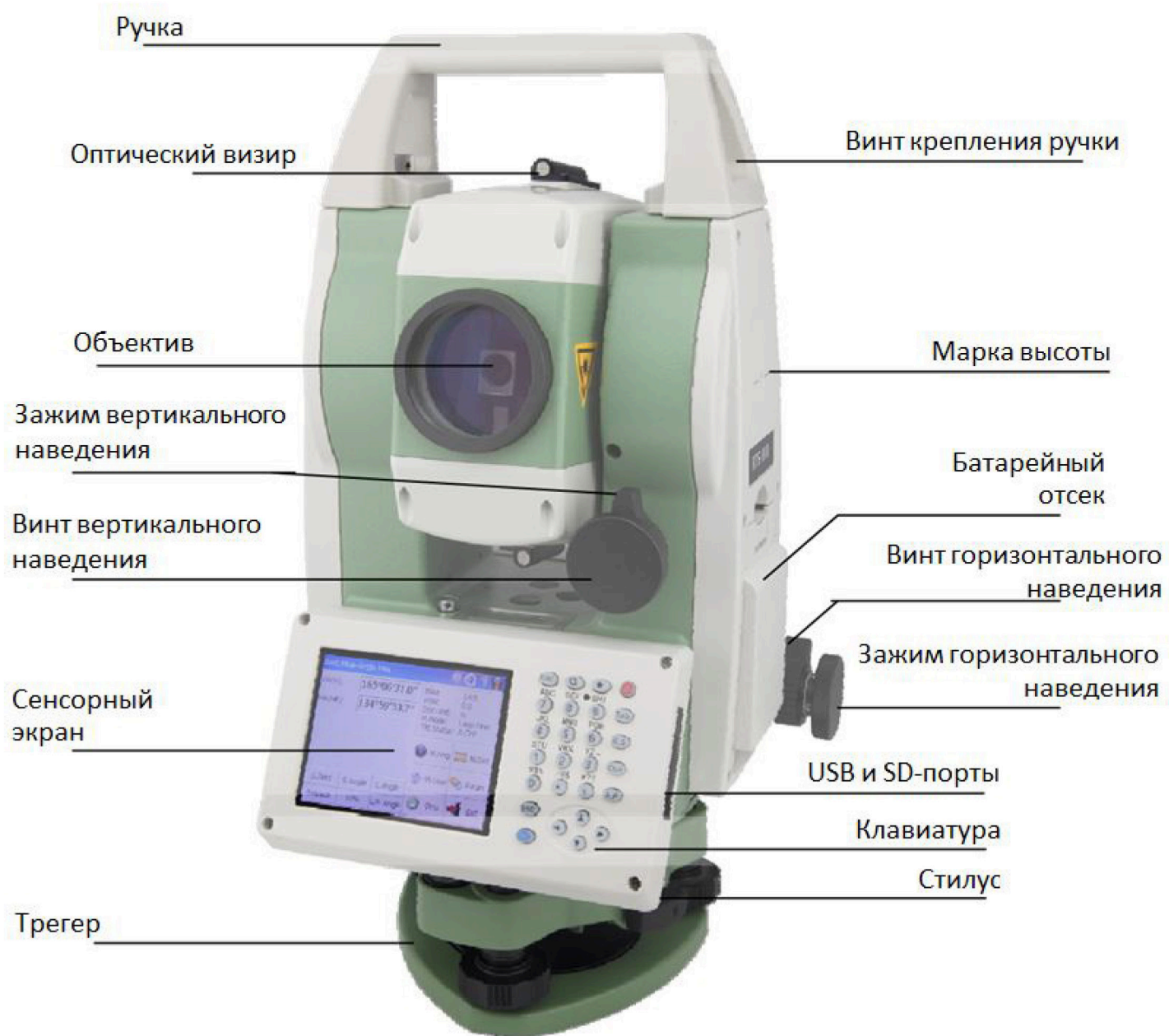
Рисунок 3 - Основные элементы тахеометра RTS010
